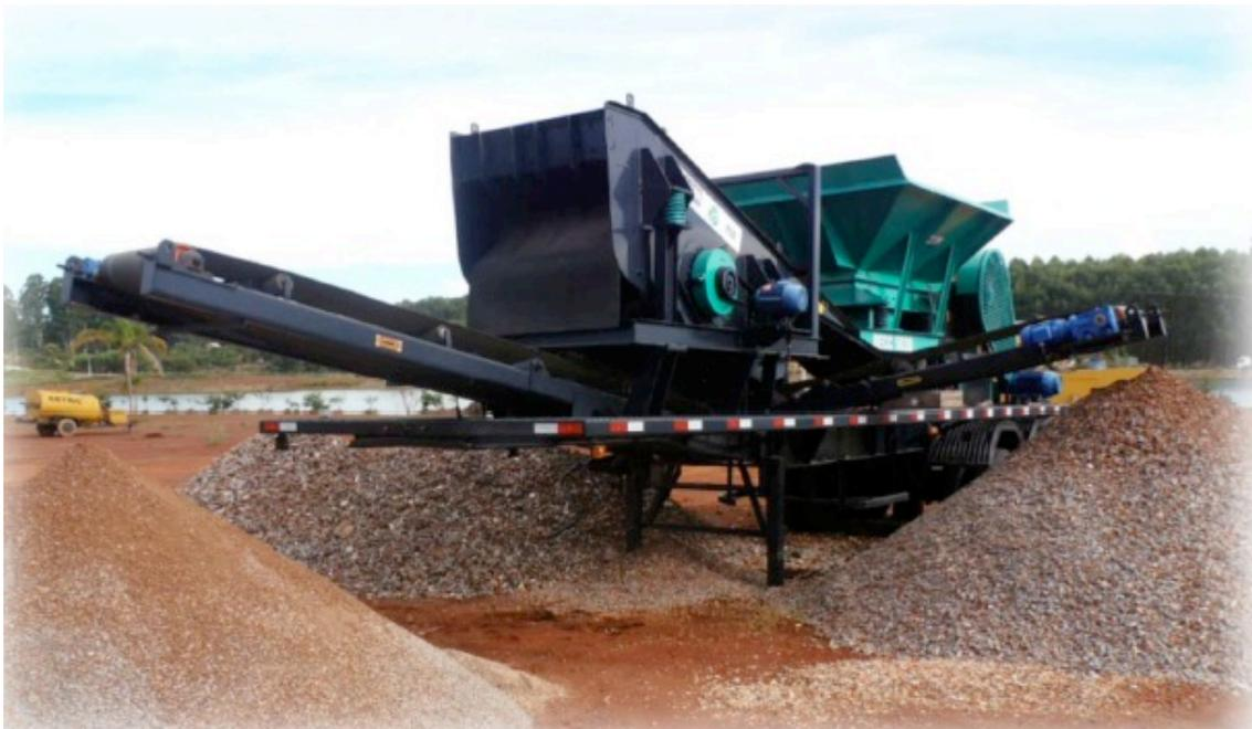
Figura 10 – Imagem da operação do tratamento dos resíduos da construção e demolição.
